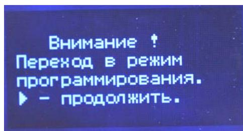
Рисунок 34. Перевод прибора в режим программирования.
